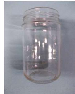
Forma: cilindrica alta – dimensioni: altezza 110±5 mm, diametro esterno corpo 65±5 mm, diametro interno bocca 55±5 mm
